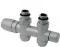
ПРЯМОЙ ВЕНТИЛЬ KRISTAL, МЕЖСЕВОВОЕ РАССТОЯНИЕ МЕЖДУ ТРУБАМИ 50 ММ С ТЕРМОСТАТОМ - МАТОВАЯ ОТДЕЛКА KRISTAL VALVE STRAIGHT PIPE CENTRES 50 MM WITH THERMOSTATIC OPTION - SATIN FINISHING
