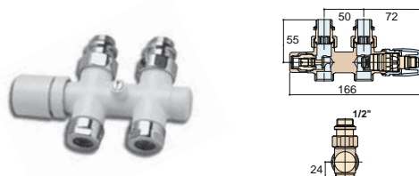
ПРАВЫЙ ПРЯМОЙ ВЕНТИЛЬ KRISTAL, МЕЖОСЕВОЕ РАССТОЯНИЕ МЕЖДУ ТРУБАМИ 50 ММ, С ТЕРМОСТАТОМ - БЕЛЫЙ R01 - RAL 9010 KRISTAL VALVE STRAIGHT RIGHT PIPE CENTRES 50 MM WITH THERMOSTATIC OPTION - WHITE R01 - RAL 9010
