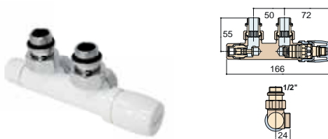
ПРАВЫЙ ПРЯМОУГОЛЬНЫЙ ВЕНТИЛЬ KRISTAL, МЕЖОСЕВОЕ РАССТОЯНИЕ МЕЖДУ ТРУБАМИ 50 ММ, С ТЕРМОСТАТОМ - БЕЛЫЙ R01 - RAL 9010 KRISTAL VALVE SQUARE RIGHT PIPE CENTRES 50 MM WITH THERMOSTATIC OPTION - WHITE R01 - RAL 9010
